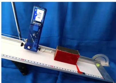
图5 测量斜面的机械效率
