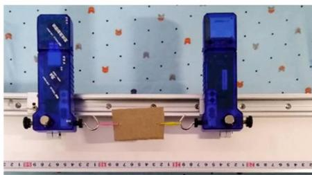
图7 平衡力实验
