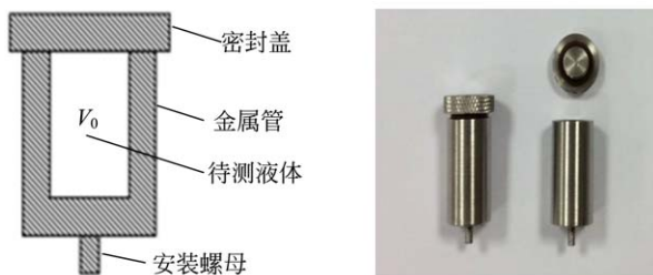
(a)示意图 (b)实物图 图 1 液体密度传感器
