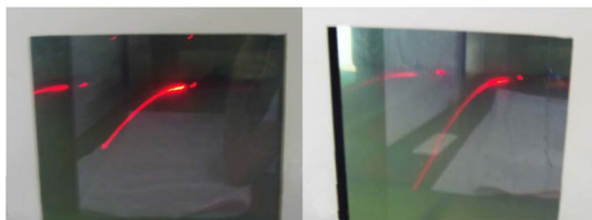
(a)清水注入后 2 h (b)清水注入后 6 h 图 3 清水注入不同时间激光穿过溶液的弯曲情况
