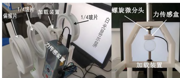
图 4 实验装置搭建与加载装置示意图
