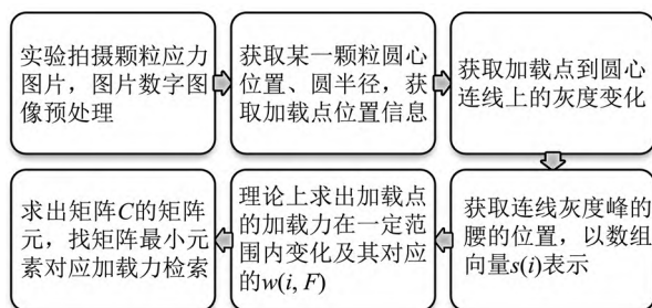
图 9 线扫描方法流程图
