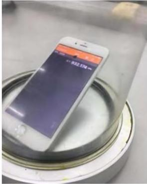
图 2 用手机显示玻意耳实验的压强变化
