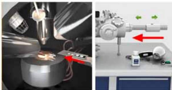
图 12 样品传送杆动作和分析室的窗口景象的同步
