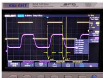
图 10 液晶的响应时间曲线
