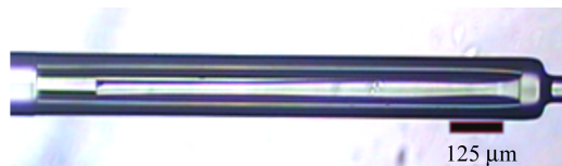
图 1 自制高灵敏度光纤 F-P 干涉型拉力传感器实物图
