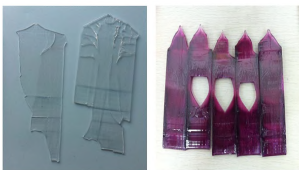
(c)晶体多晶开裂 (d)红宝石晶片内部缺失
