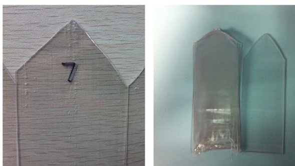
(a)肉眼可见的气泡 (b)原料污染导致的晶体显色
