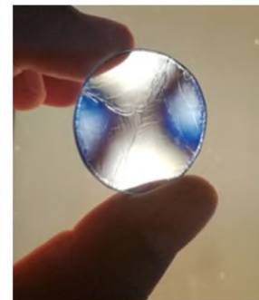
(d) 尖晶石晶体内部晶界及杂质缺陷分布
