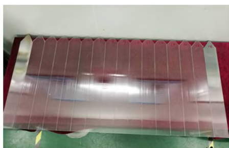
图 5 多片导模法蓝宝石晶体同步生长单炉晶体照片
