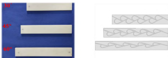
图 3 特斯拉阀实物与 CAD 透视图示意图
