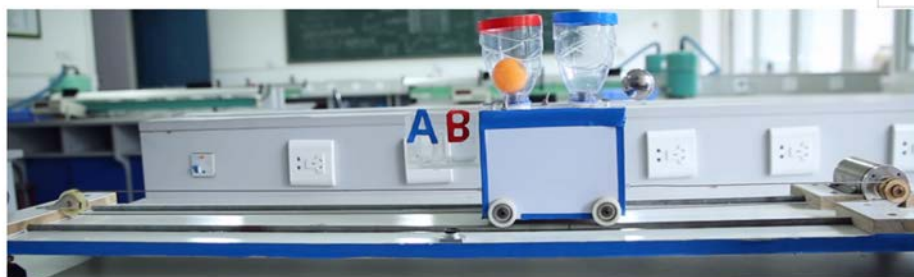
图 1 多功能惯性定律演示仪实物图
