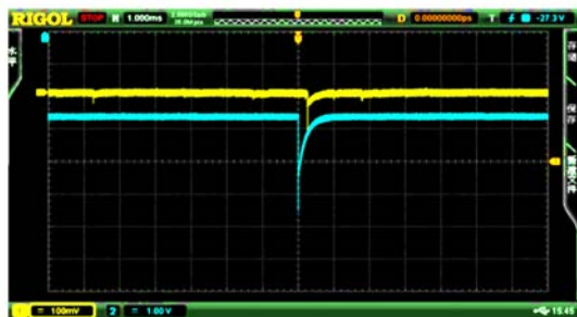
图 2 示波器显示 2 块塑料闪烁体的宇生 \mu 子脉冲波形
