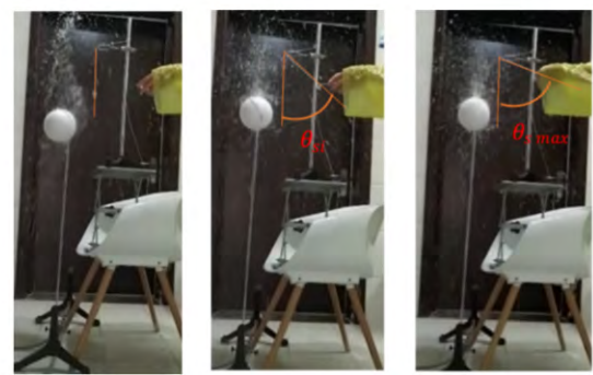
(a) 静止 (b) 拉开砝码 (c) 临界释放角
