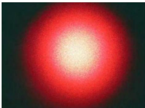
图 1 利用相机拍摄的激光散斑
