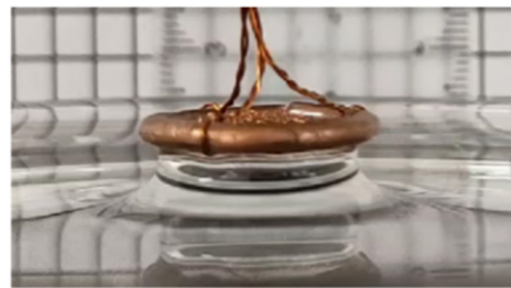
(a)水膜断裂照片
