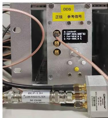
图 7 参考信号发生器和混频器
