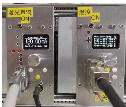
图 6 温控器与激光直流控制器
