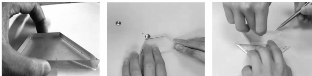
(a) 手直接拿取玻璃砖 (b) 圆钉代替大头针 (c) 直接用笔靠着玻璃砖画线
