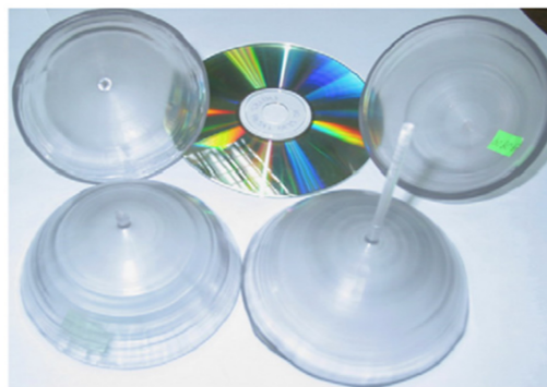
图 3 钟罩形的蓝宝石晶体 [17]
