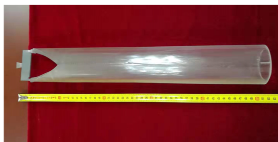
图 5 同济大学生长的大口径蓝宝石圆管
