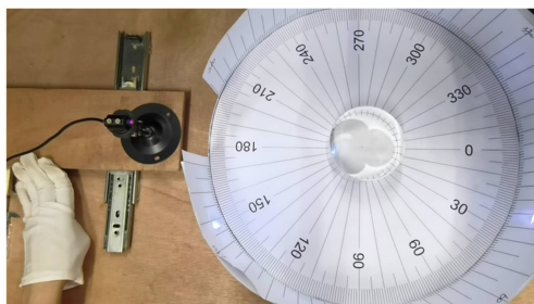
图 12 使用单色激光照射圆柱
