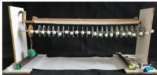
图 4 机械振动与机械波多功能演示装置
