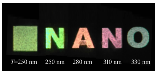
(b)不同周期下金属 SP 腔的光学显微镜照片 图 10 不同周期的金属 SP 腔实验图 [13]
