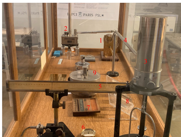
1. 电离室 2. 静电计 3. 石英压电天平 4. 导线(同轴电缆) 5. 标尺 6. 秒表 7. 砝码盒 8. 压电石英晶体样品 9. 原实验中的电离室
