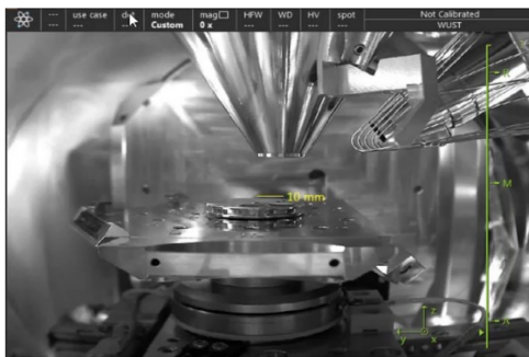
图 13 调整样品台高度以及设置拍照界面场景界面
