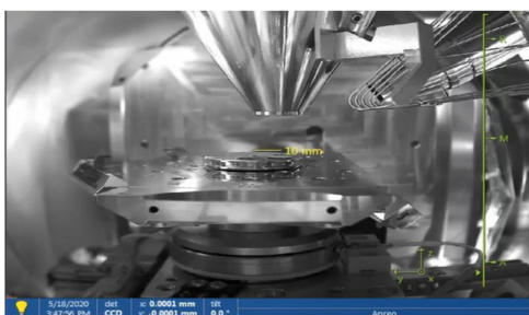
图 7 扫描电子显微镜的内部主要构造
