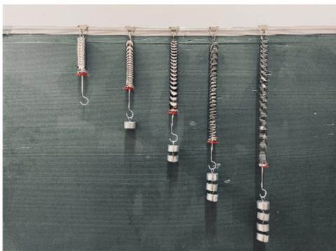
图 8 钩码数量与弹簧伸长量的线性关系
