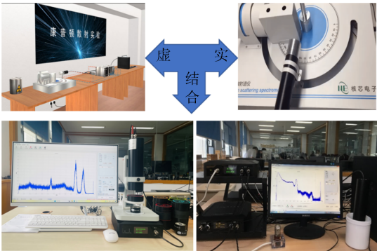
图 5 虚实结合康普顿散射实验系统整体结构
