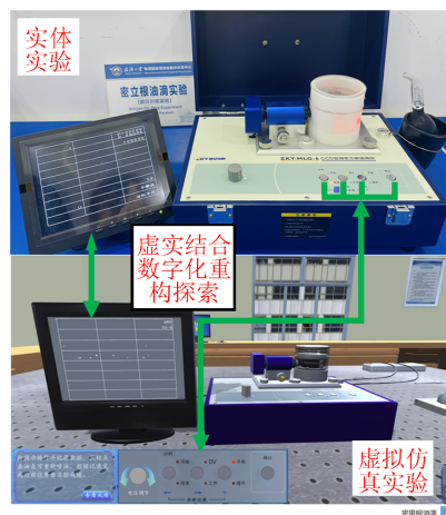
图 8 密立根油滴实验实体、虚拟仿真及虚实结合数字化重构实验
