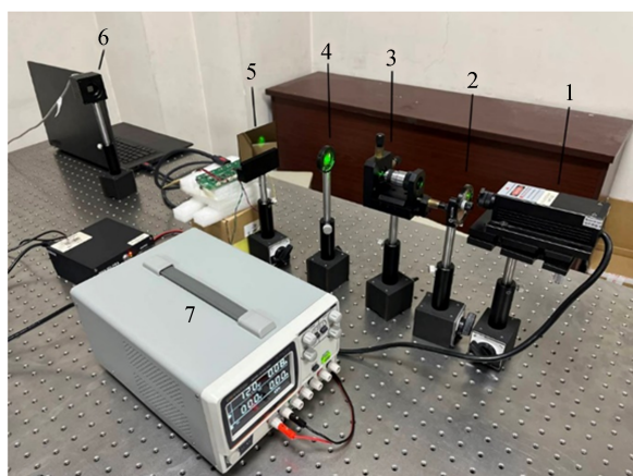
1. 半导体激光器 2. 衰减片 3. 扩束镜 4. 准直镜 5. LCD 6. 摄像机 7. 学生电源
